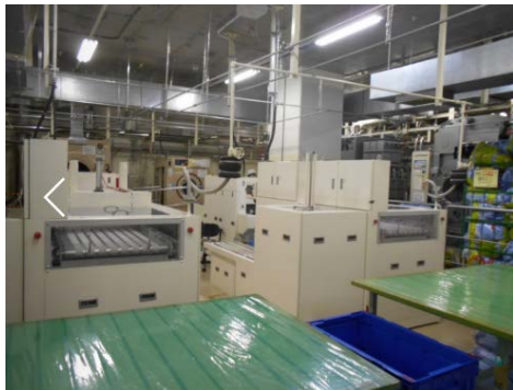
ランドリーモニタ (管理服等の汚染検査)
